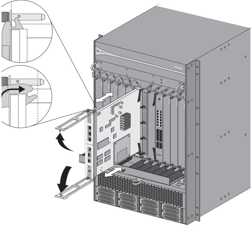
٦- قم بإزالة SMC من الكيس المقاوم للكهرباء الساكنة المضاد وأدخلها في فتحة SMC، لضمان أن المقابض في وضع فتح. عندما تصبح البطاقة بطول ١/٤ بوصة تقريبًا بعد إدخالها بالكامل، اضبط الأذرع للمحاذاة مع الشاسيه ثم أغلق الأذرع لوضع البطاقة في مكانها.
